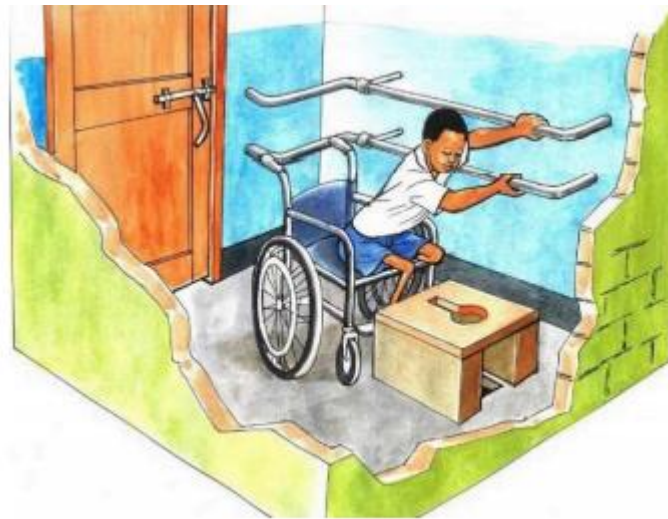
Figure 42 Toilette en Tanzanie avec un tabouret de toilettes et des barres d'appui, Source : Gouvernement de Tnzanie.
