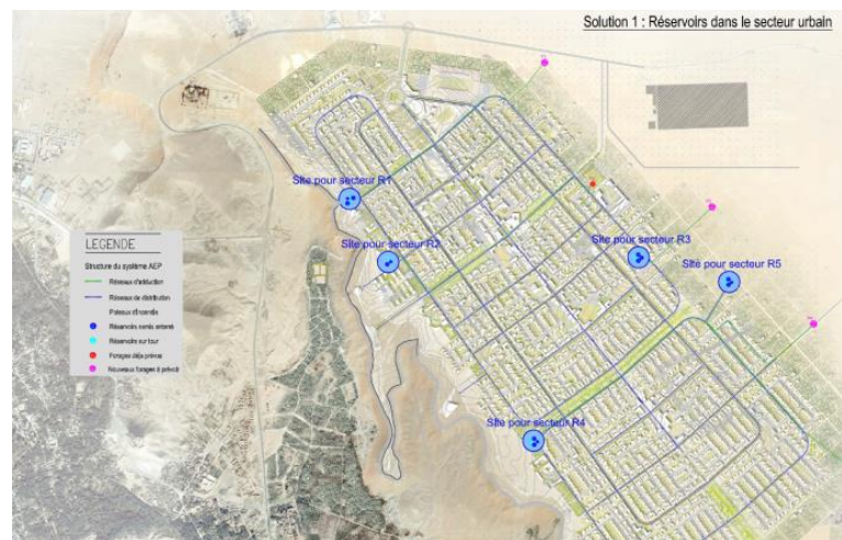
Figure III-32 : Réseau d'alimentation en eau potable Source : Egis 2012
