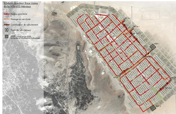
Figure III-33 : Réseau des eaux usées Source : Egis 2012
