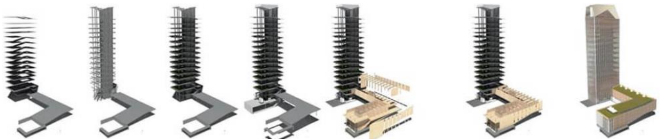
Figure : Axométrie structurelle du centre Source : https://www.asa-lyon.fr/portfolio/projet-rheintal-valley/
