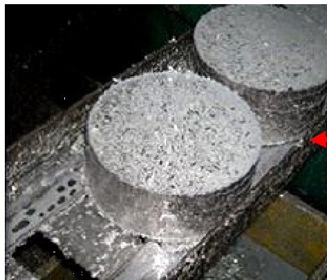
Fig III. 6 : les copeaux après le compactage (forme rondin).
