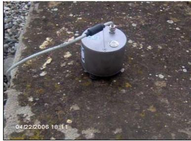
Photo 3.1 : Capteur de vibrations
