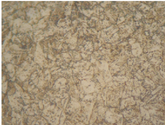
Figure .IV.2 micrographie après vieillissement à 450 °C/4h (X1000)
