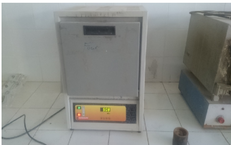
Figure IV.3 : four électrique à moufle.
