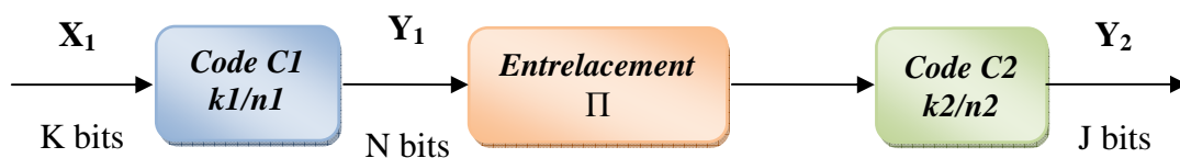
Figure 4.19 : schématisation d'un turbo codeur série.
