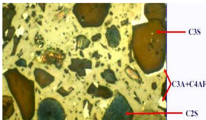
**Figure 1.8 Vue microscopique d'une lame mince de clinker [2]**
