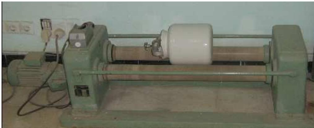
**Figure 3.4 : Dispositif expérimental du broyage.**
