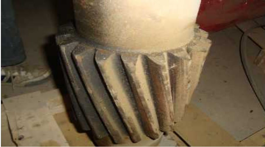
Figure IV.22: Partie d'engrenage endommagé
