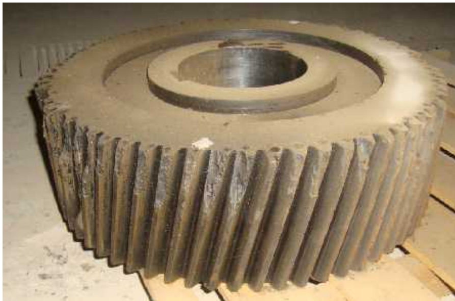
Figure IV.23: Roue dentée endommagée
