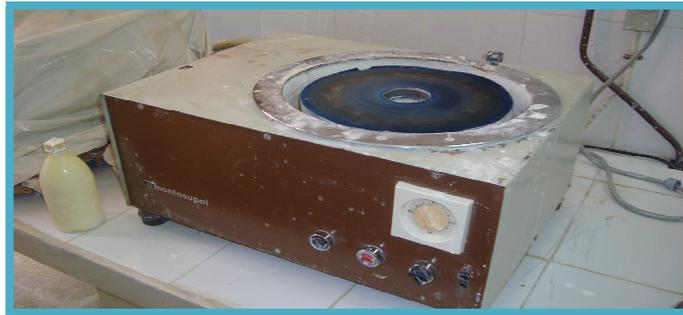
**Figure III-14 :** Polisseuse de finition.
