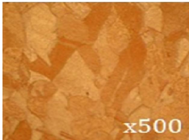
**Figure IV-10:** la microstructure de cuivre.
