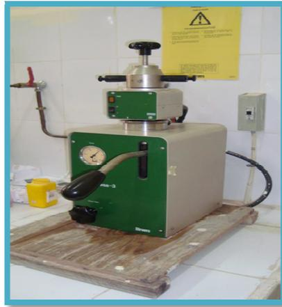
**Figure III-12** : Enrobeuse STRUERS.
