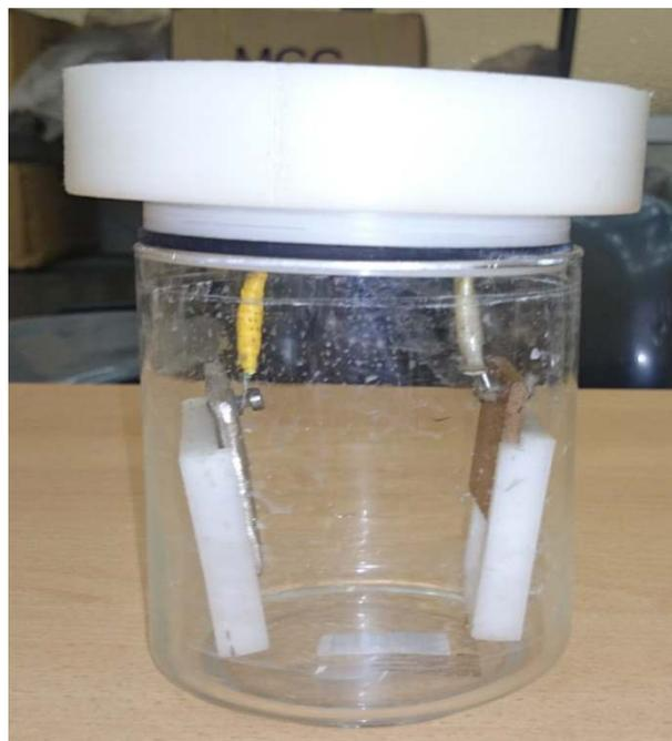
**Figure III-3 :** Cellule de l'électrodéposition.
