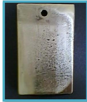
**Figure III-6 :** Anode en nickel pur.
