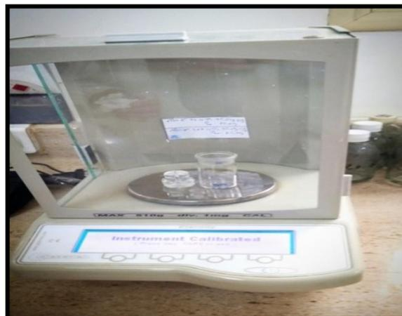
Figure 44: La balance et pycnomètre.
