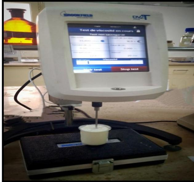
Figure 43: Mesure de la viscosité.
