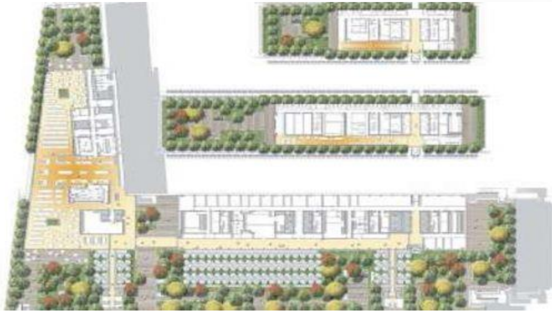
Fig. II-51 : Plan des terrasses du socle et de l'IGH situées au niveau des tailles de guêpe
