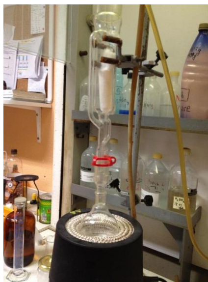
Figure VI.3. Un dispositif de Soxhlet
