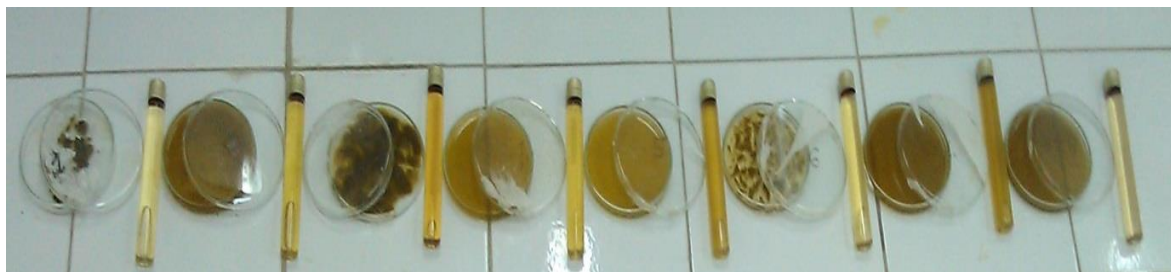
Figure VII.12. Après la filtration, les microparticules (filtrats) sont dans les boîtes à pétrie et les substances filtrées sont dans les tubes à essaies.
