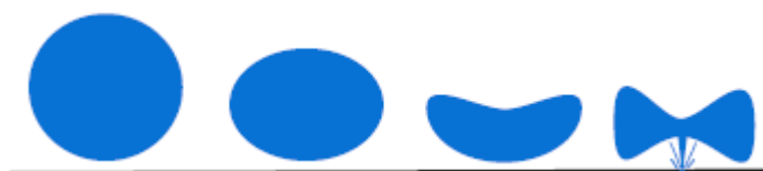
Figure III.3. Évolution d'une bulle de cavitation à proximité d'une surface solide.
