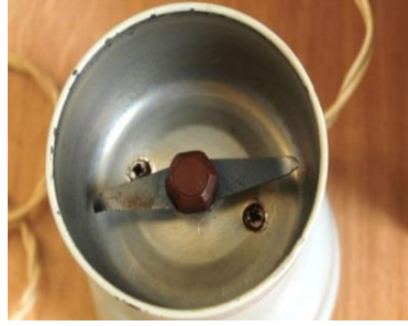
Figure VI.2.Moulin utilisé pour le broyage
