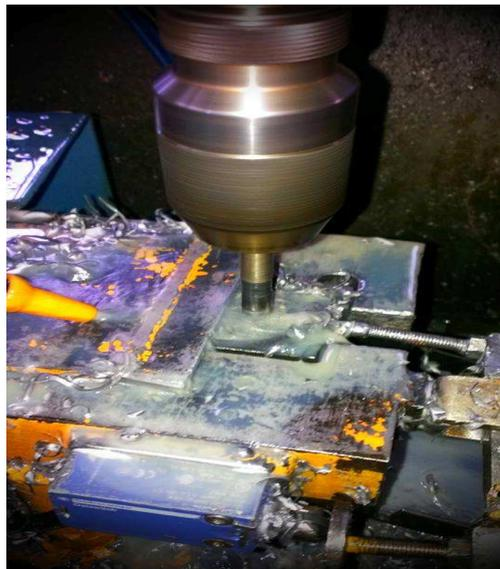
Figure I.3.Opération perçage des lames
