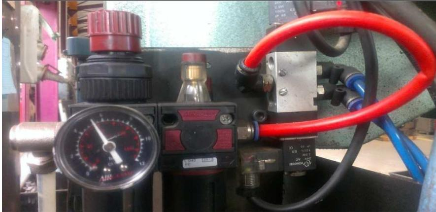
Figure IV.6. Distributeur et échangeur de pression
