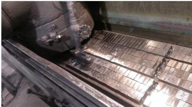
Figure I.4. Rectification des lames
