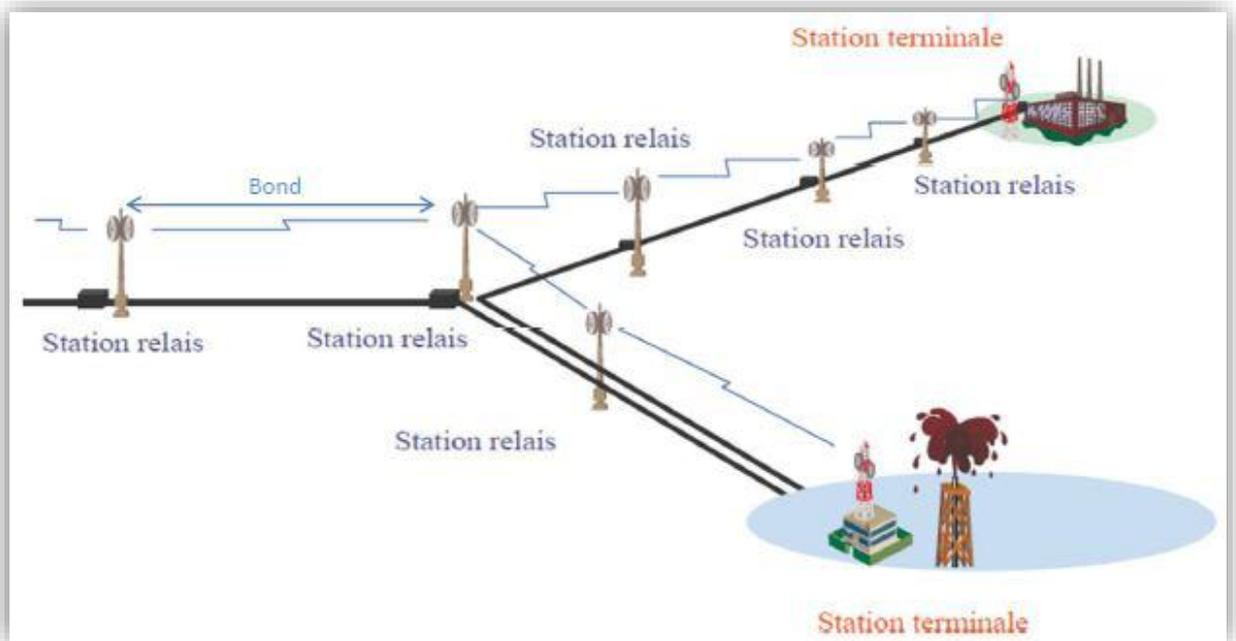
*Figure 2. 2:* Structure générale d'une liaison hertzienne.
