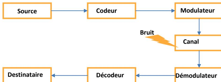
Figure 1.1: Schéma simplifié d'un système de transmission numérique.
