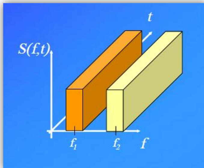
Figure 1. 16: Principe du multiplexage FDM.
