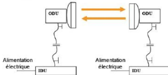
*Figure 2. 10:* Schéma synoptique d'une transmission Haut débit.
