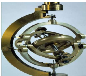
Figure 1.10.a : Gyroscope mécanique de Foucault.
