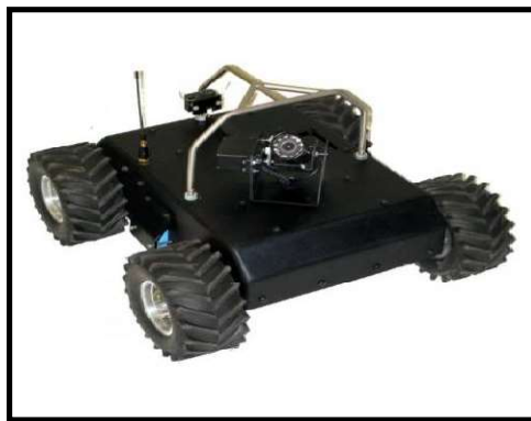
Figure 1.6 : Exemple d'un robot mobile à des roues.
