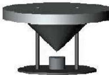
Figure 3.6 : émetteur ultrasonique et son cône de réflexion
