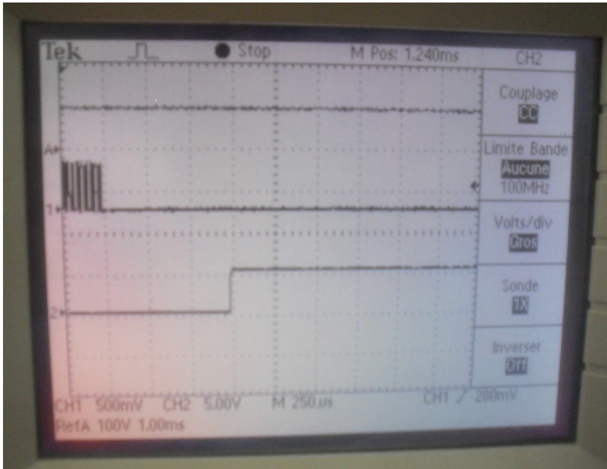
Figure 4.5 : Affichage sur oscilloscope d'un signal ultrason émis et reçu.
