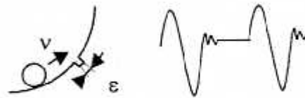
Fig. 2-30 Le passage d'une bille sur une défautuosité provoquant un choc
