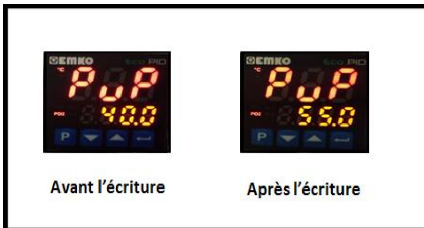
Figure 1b.3 Résultat de l'écriture du registre PuP de menu PrS dans le régulateur.
