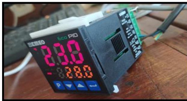
Figure (2.2) Le régulateur de température EMKO eco PID.
