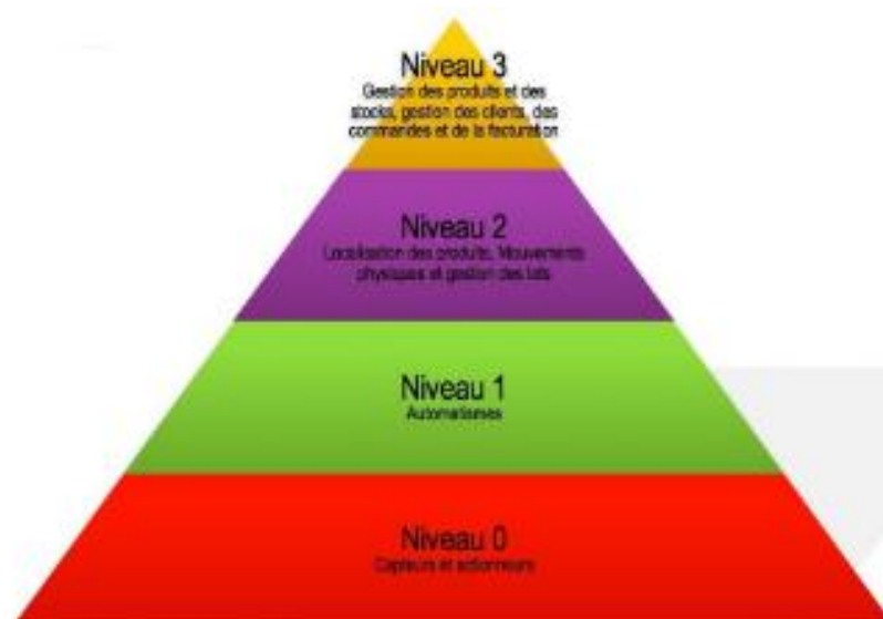
Figure (1.1) les 4 niveaux hiérarchiques d'un système de contrôle industriel [6].
