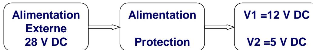
L'alimentation externe de 28VDC est appliquée à l'entrée du bloc alimentation et protection de l'indicateur, et génère deux tensions d'exploitation V1 et V2
