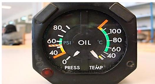
Figure.III.2. L'indicateur double température /pression d'huile.
