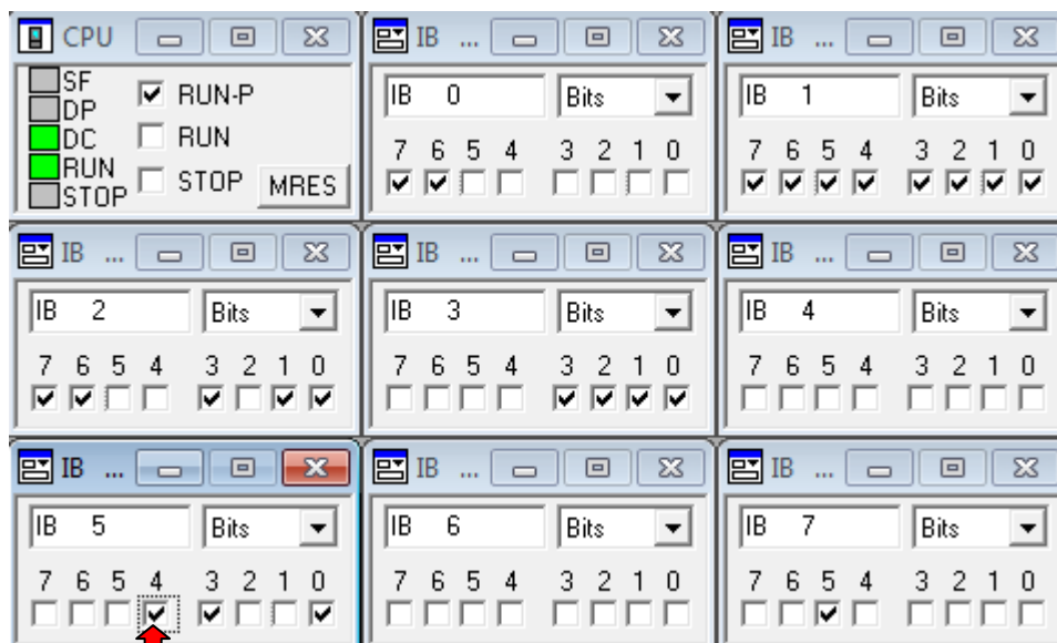
Figure IV.40 État des entrées pour détection basse pression en linge des brûleurs.
