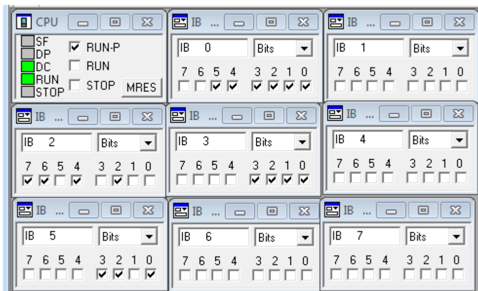
Figure IV.22 Etat des entrées pour démarrer la soufflante.
