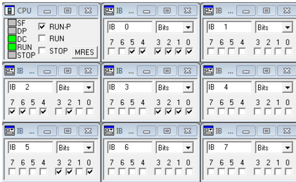
Figure IV.28 Etat des entrées pour l'arrêt d'urgence du four.
