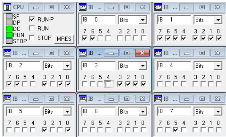
Figure IV.34 Etat des entrées pour arrêt d’urgence du brûleur.
