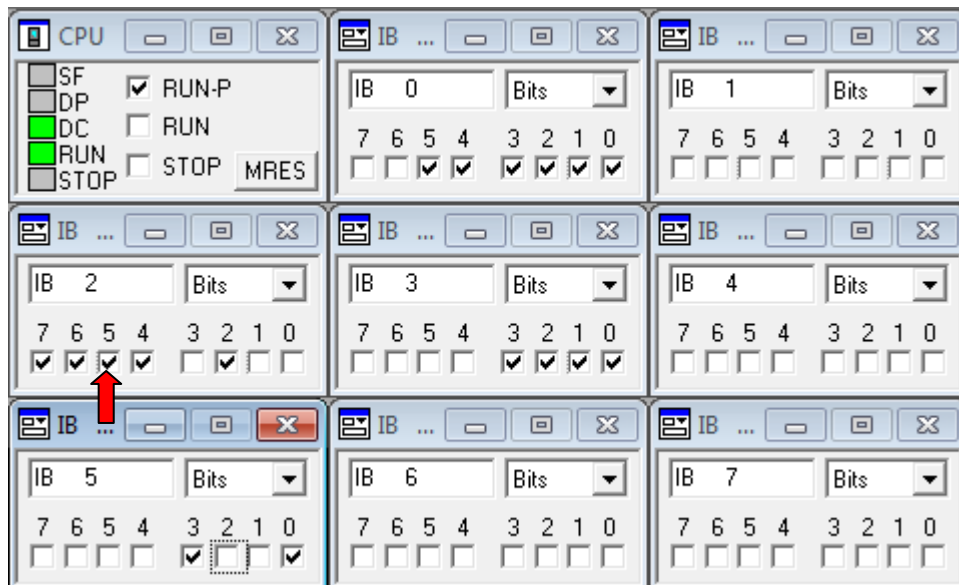
Figure IV.38 Etat des entrées pour détection basse pression en ligne des pilotes.
