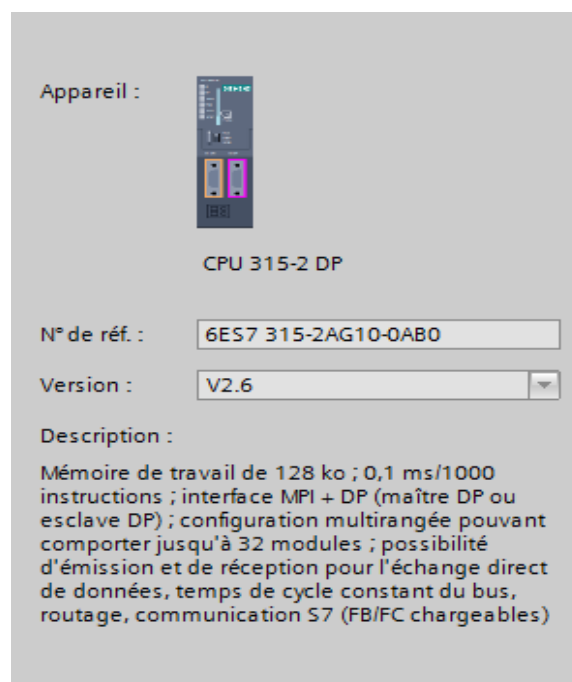
Figure IV.5 Description de l'appareil ajouté.
