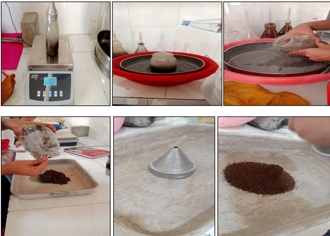
**Figure 2.3** : Essai de la masse volumique absolue des sables légers.
