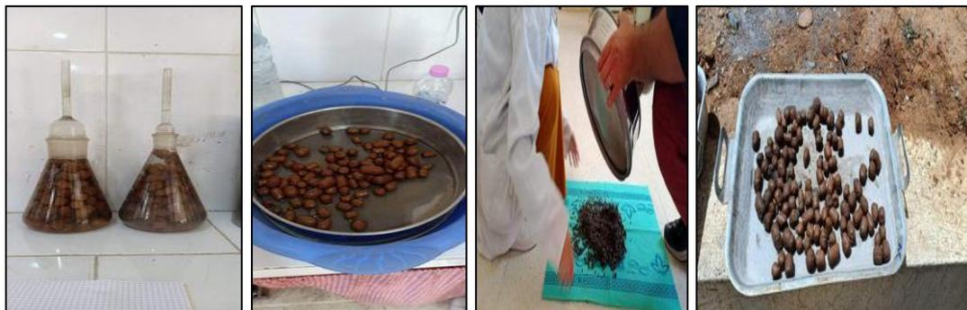
**Figure 2.13** : Etape de réalisation de l'essai de la masse volumique absolue des granulats légers.
