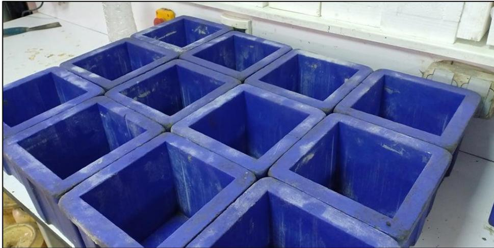
**Figure 2.21** : Moules cubiques de  $15*15*15 \text{ cm}^3$ .
