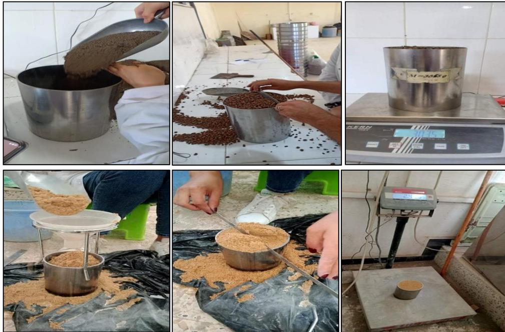
**Figure 2.2** : Essai de la masse volumique apparente.
