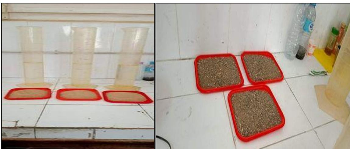
**Figure 2.4:** Essai de la masse volumique apparente.
