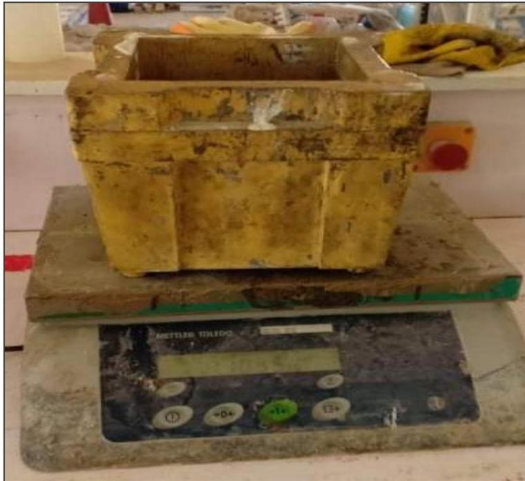
**Figure 2.24:** Essais de la masse volumique des bétons à l'état frais.
