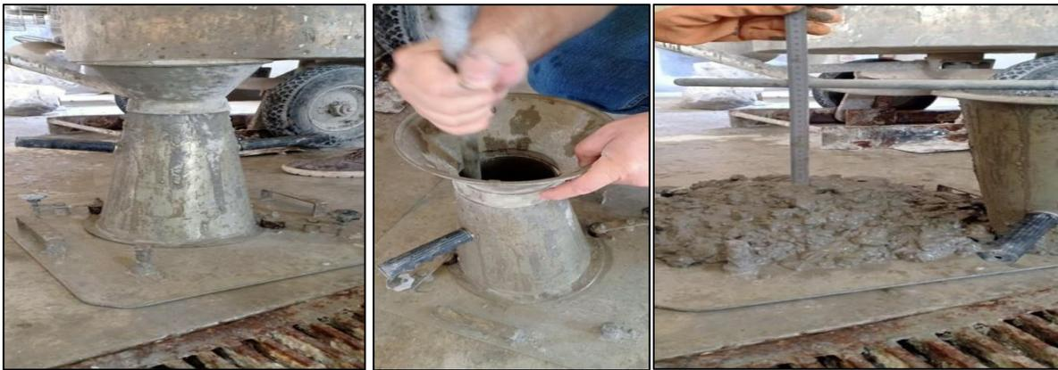
**Figure 2.25** : Etapes de réalisation de l'essai du cône d'Abrams.
