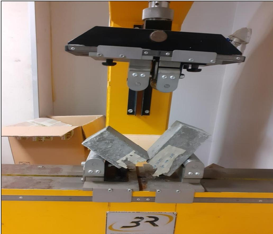
**Figure 2.27:** Dispositif d'essai de flexion.
