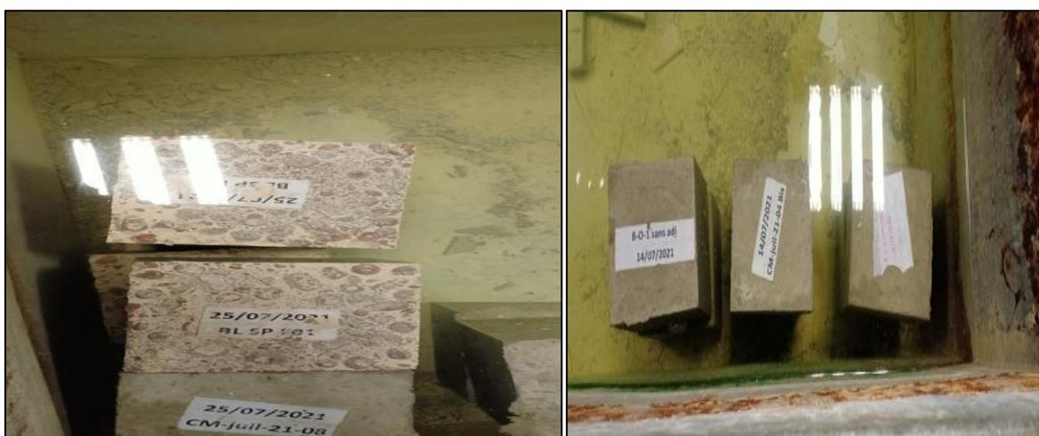
**Figure 2.23 :** Conservation des moules dans des bacs à eau.
