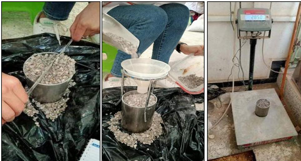
**Figure 2.11** : Essai de la masse volumique apparente.
