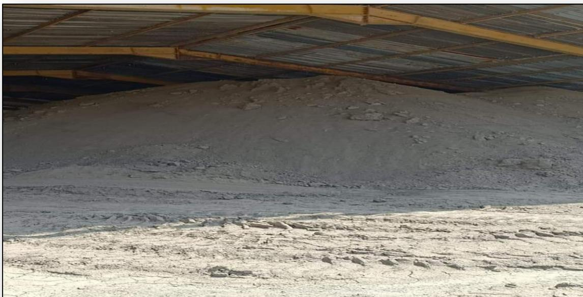
**Figure 1.15 :** Le dépôt de la matière première après concassage.
