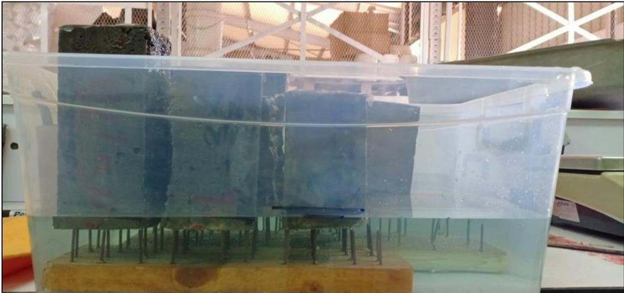
**Figure 2.29** : Dispositif expérimental de l'essai d'absorption capillaire.
