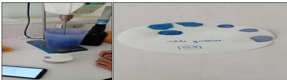
**Figure 2.6:** Réalisation de l'essai de VB.
