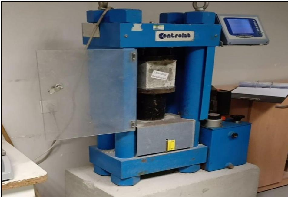
**Figure 2.26:** Dispositif de l'essai de compression des bétons.
