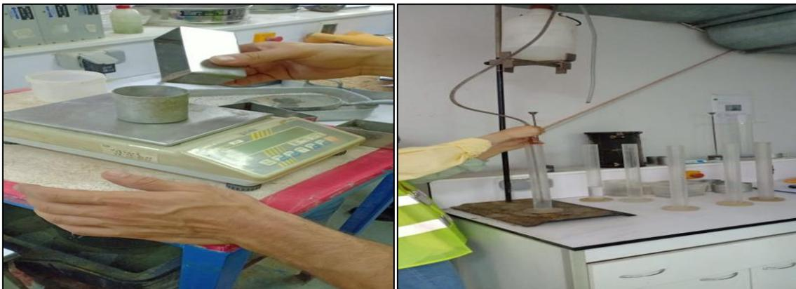
**Figure 2.5:**Essai de l'équivalent de sable.
