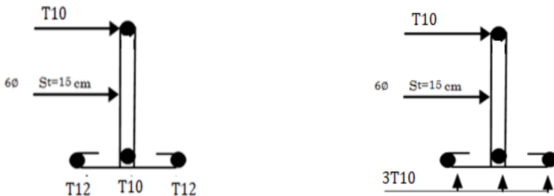
FigureIII.07 : schéma de Ferrailages de la poutrelle (type 1) en travées et en appuis.
