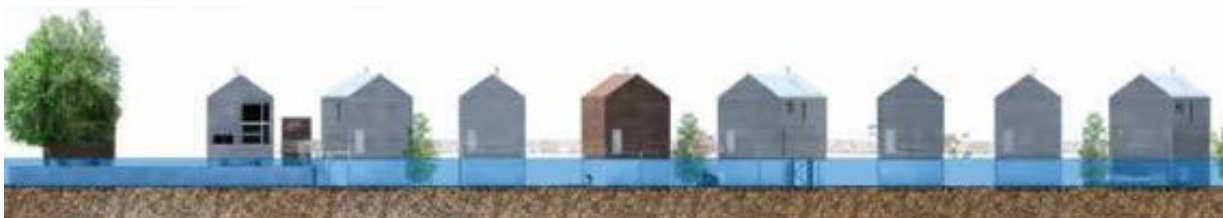
Coupe transversale montrant l'installation des logements au-dessus du niveau des plus hautes eaux connues.
