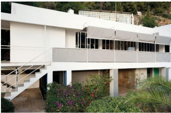
Système de couvertures rabattables faisant office de brise soleil. Source : wikiarquitectura.com
