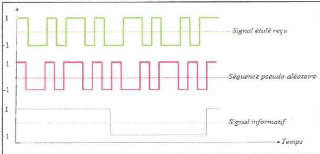
Figure 2.4. Désétalement du signal.
