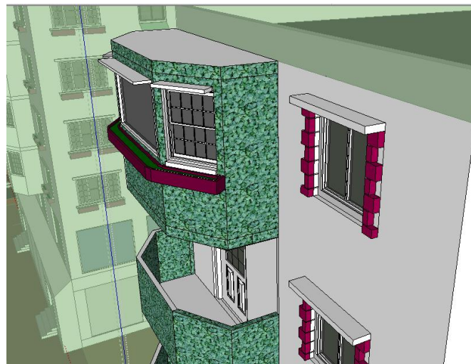
Figure 166: installation des bow-windows au niveau des façades sud (source: auteur)
