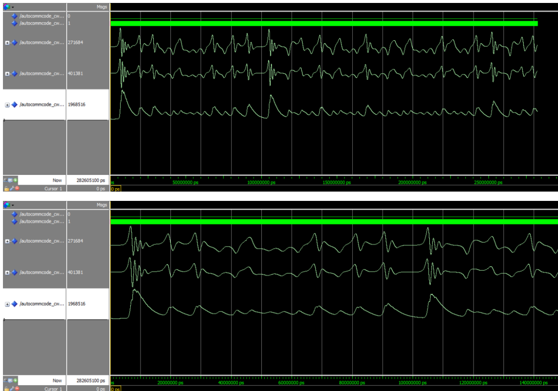
Figure 3.16. Représentation des signaux du système chaotique Auto-commuté sous Modelsim.
