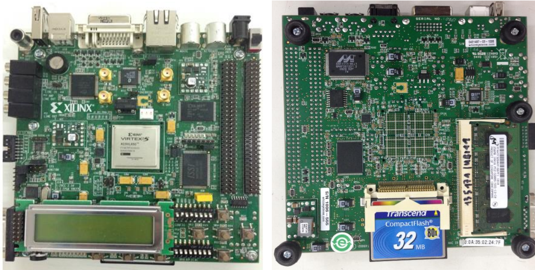
Figure 3.7. Plateforme de développement Virtex-5-ML501.
