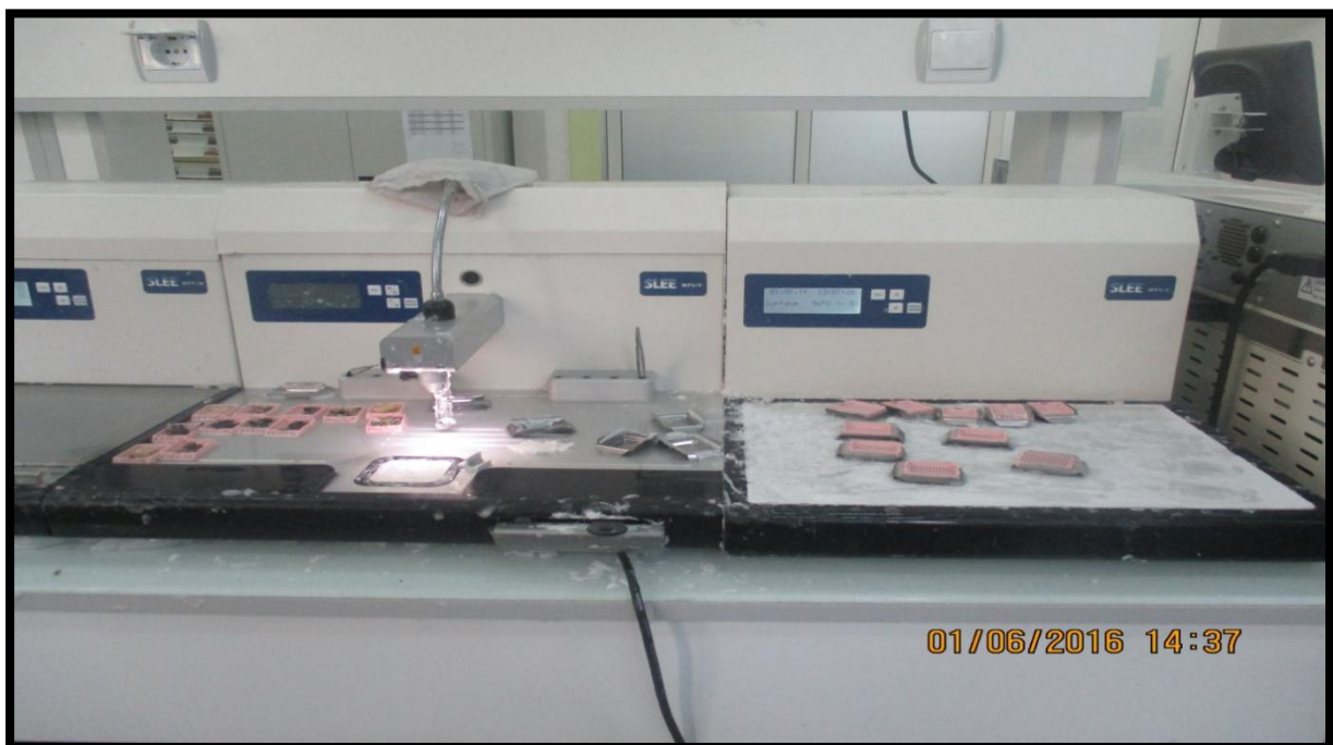
Figure8: L'enrobage de l'échantillon a la paraffine.
