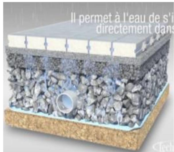
Figure 122 : Pavage perméable
