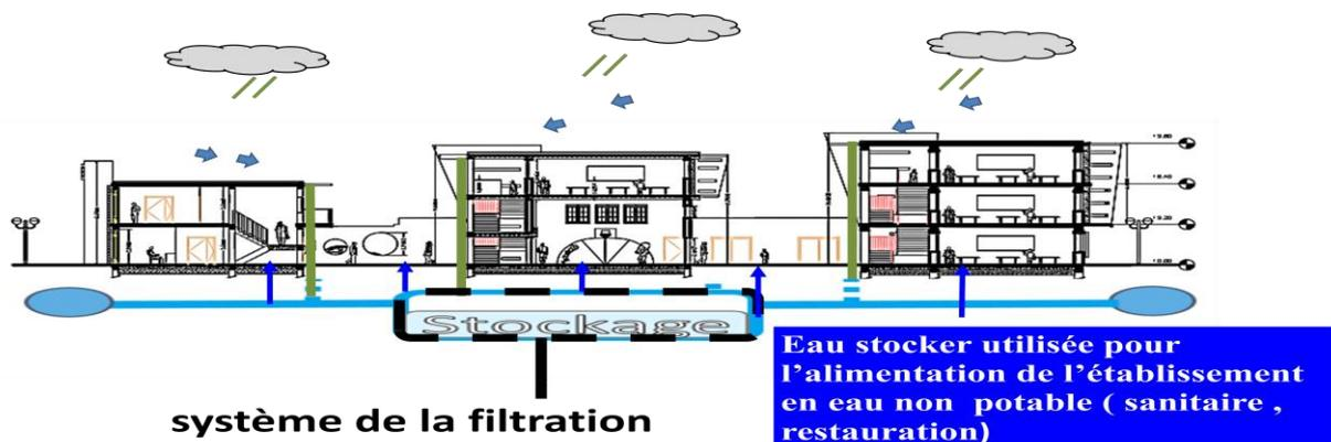
Figure 125:système de la filtration
