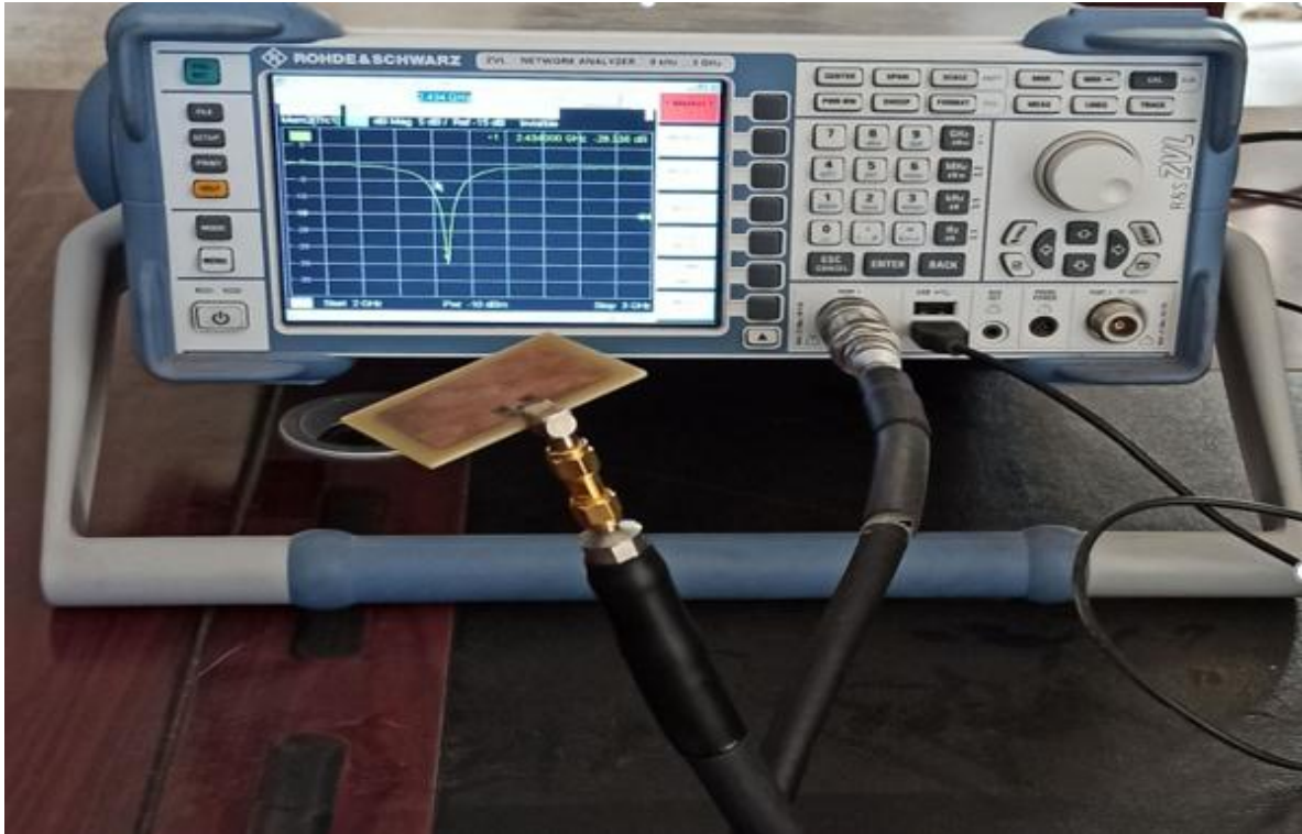
Figure IV.04: antenne patch réalisé connecté avec l'analyseur de réseau.
