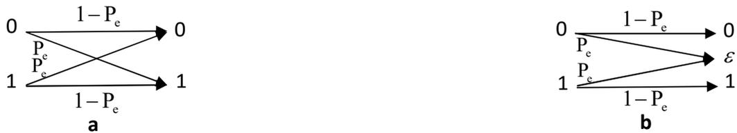
**Figure 2.3.** a) canal binaire symétrique (BSC) avec  $0 \leq P_e \leq 1/2$ , b) canal binaire à effacement (BEC) avec  $\epsilon$  l'effacement et  $P_e$  la probabilité de l'effacement.
