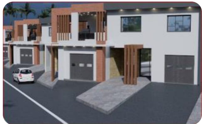
Figure 129 :Des protections solaire ( façade principale) source : Auteur
