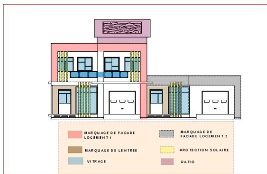
Figure 102 : Façade principale de la 1ere unité source : Auteur
