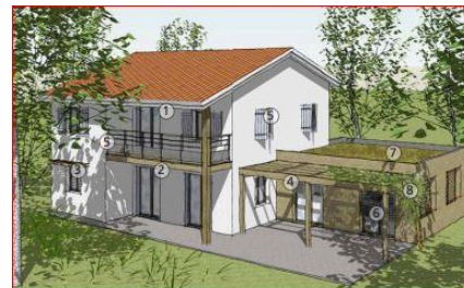
Figure 32 :Une maison conçue pour assurer un bon confort d'été 1. Débord de toiture 2. Balcon 3. Casquette 4. Pergola 5. Contrevents en bois 6. Store extérieur 7. Terrasse végétalisée 8. Treille végétalisée
