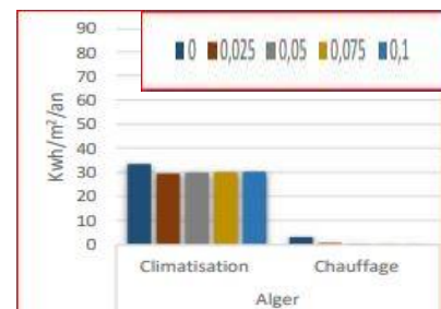
Figure 54 : Impact de l'isolation thermique de l'enveloppe sur l'intensité énergétique de la climatisation et du chauffage. Source : Mr Sofiane RAHMOUNI 2019 /2020
