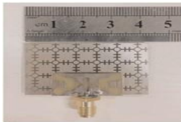
Figure 2.24 Prototype fabriqué de l'antenne en boucle
