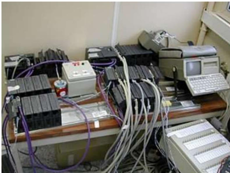
**Figure 3.1** Deux automates programmables Industriels et leurs périphériques, montés en volant, pour test et analyse.
