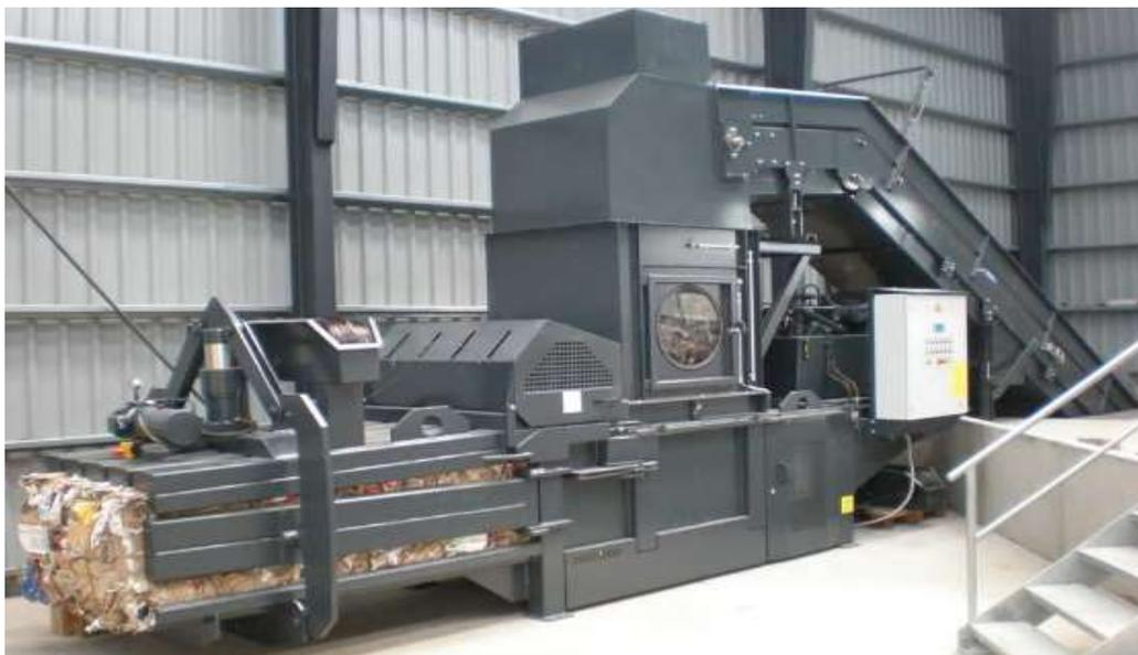
**Figure 2.3** Presse à balle horizontale
