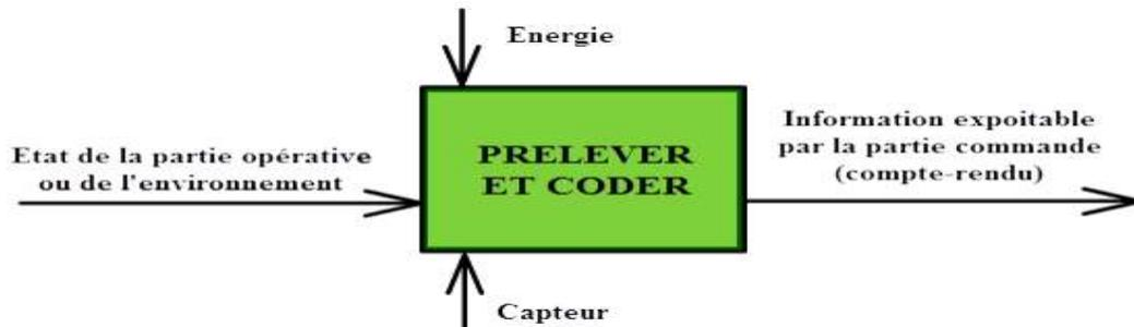
Figure 3.6 Rôle d'un capteur
