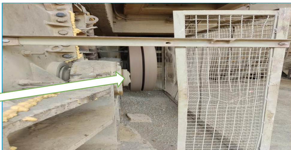
Figure 5.11: arbre cisillé de concasseur FCB
