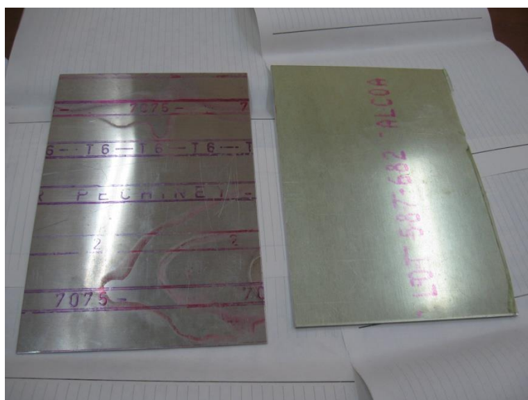
Figure 3.1 : Plaque brute d'aluminium 7075 T6 (épaisseur = 2 mm)
