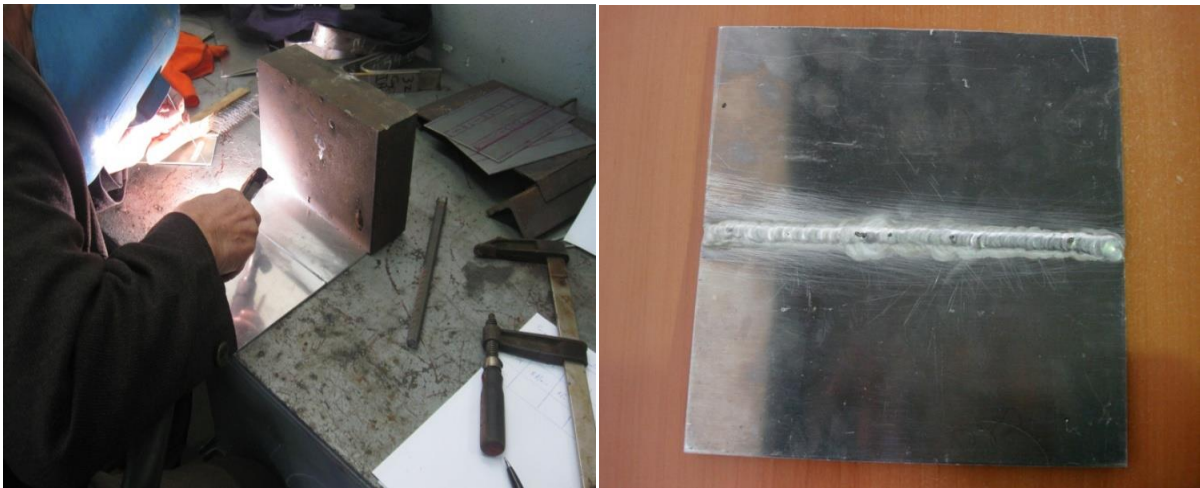
Figure 3.7 : Plaques soudées (épaisseur = 2.5 mm)
