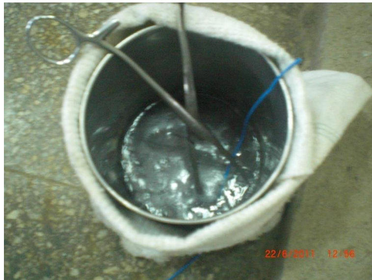
Figure 4.34: Obtention d'une température souhaitée à l'aide d'un thermocouple
