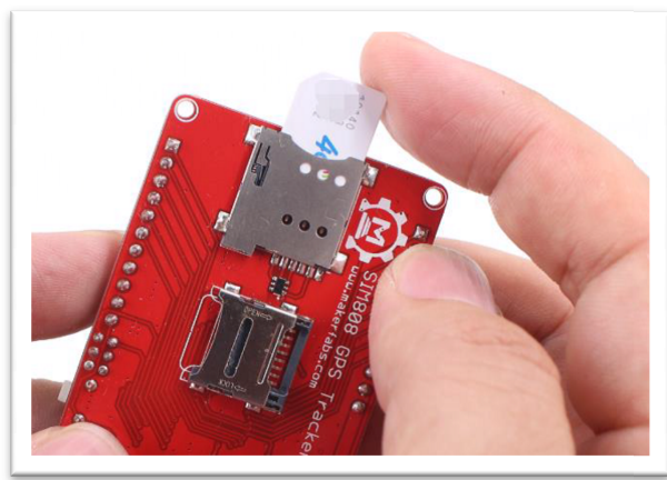
Fig. (II.16) :Insertion de la carte Micro SIM
