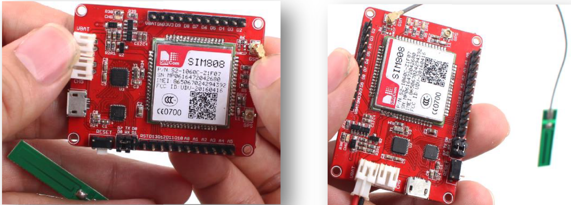
Fig. (II.17) : connexion de l'antenne GSM et la batterie
