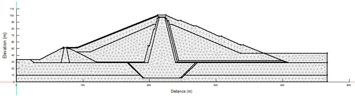
Figure VI.6 : Maillage de calcul 1504 nœuds, 2798 éléments.
