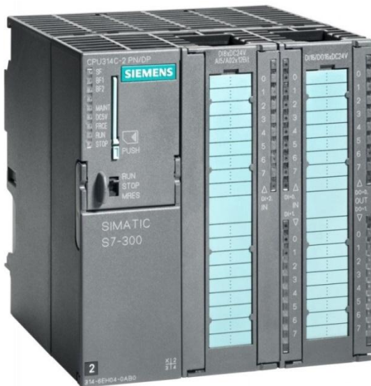
Figure35 : API Siemens S-314C-DP et ses caractéristiques.
