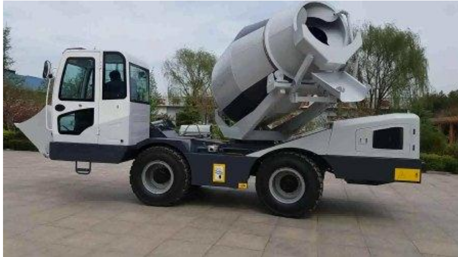
Figure11 : malaxeur à tambour sur camion.
