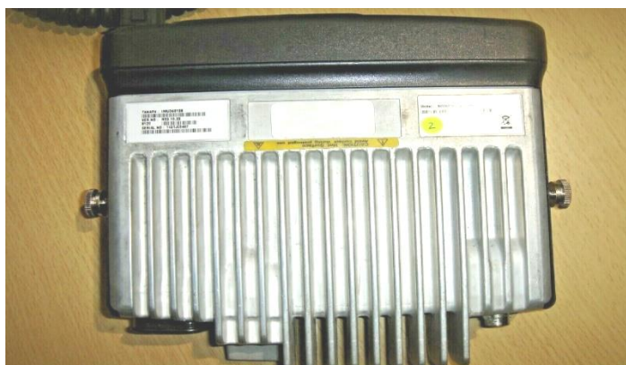
Figure 3.2 La face arrière du coffret MOTOROLA GM340
