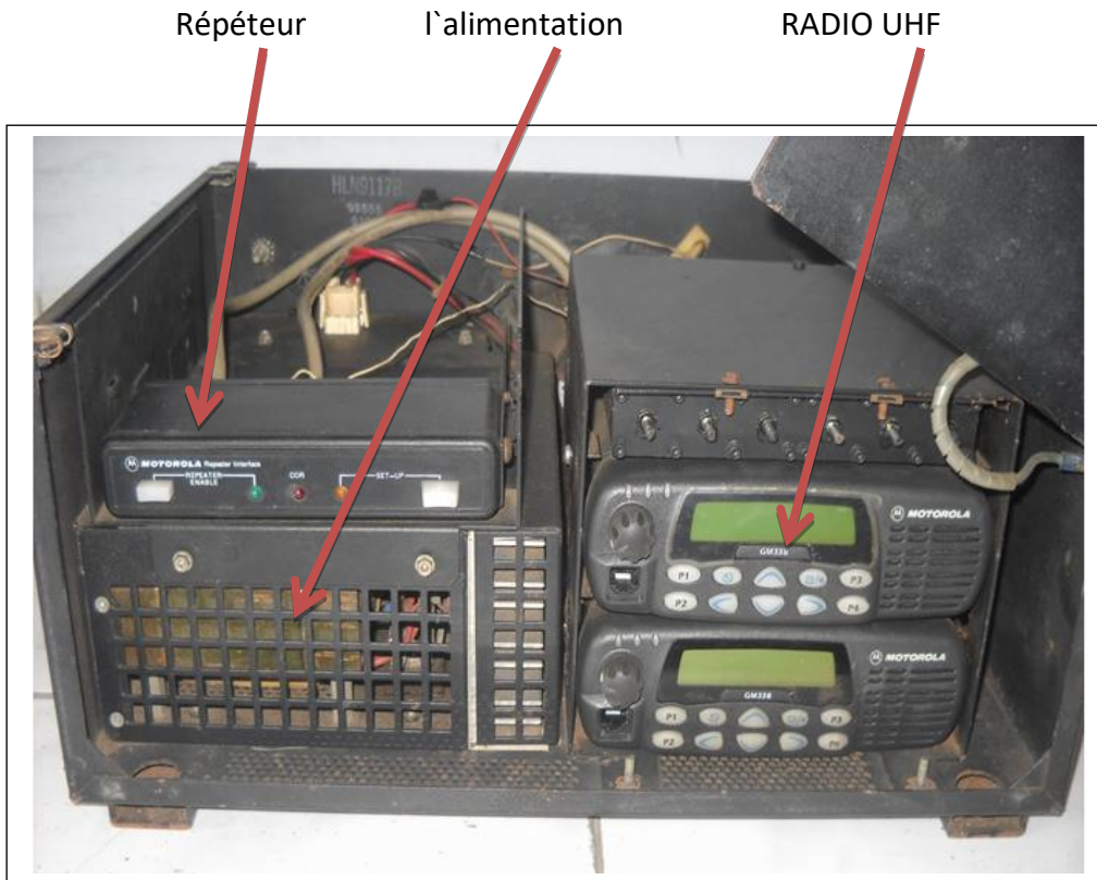
Figure3.3 présentation du relai de transmission RADIO de CHREA
