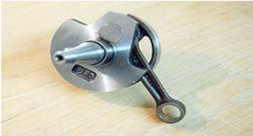
Figure. II .16. Le maneton. Partie du vilebrequin portant la bielle
