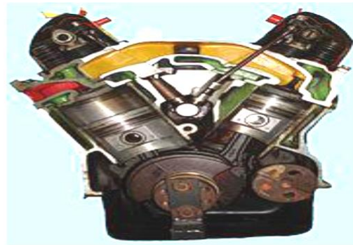
Figure. II.2. Coupe transversale d'un moteur V4.
