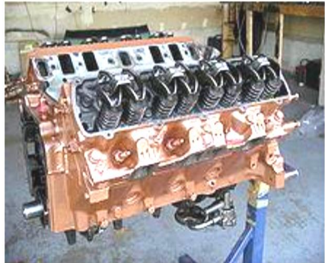
Figure.II.5. bloc cylindre (v8).
