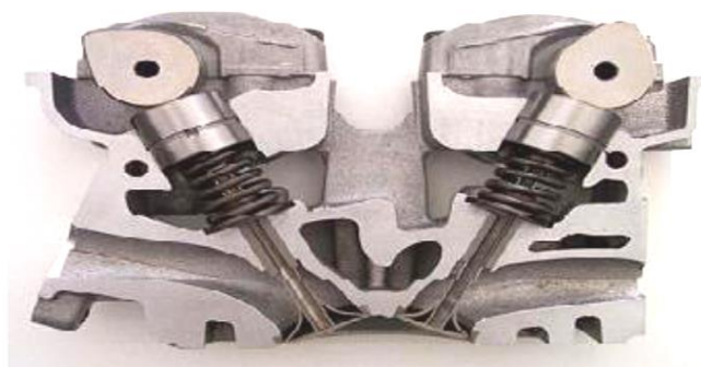
Figure. II.3. une culasse avec double arbre à cames en tête en cours de fonctionnement.
