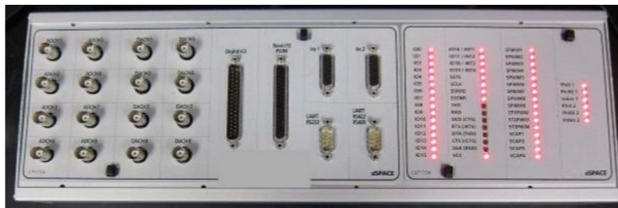
Figure 4.3. Interface de la carte dSPACE DS1104
