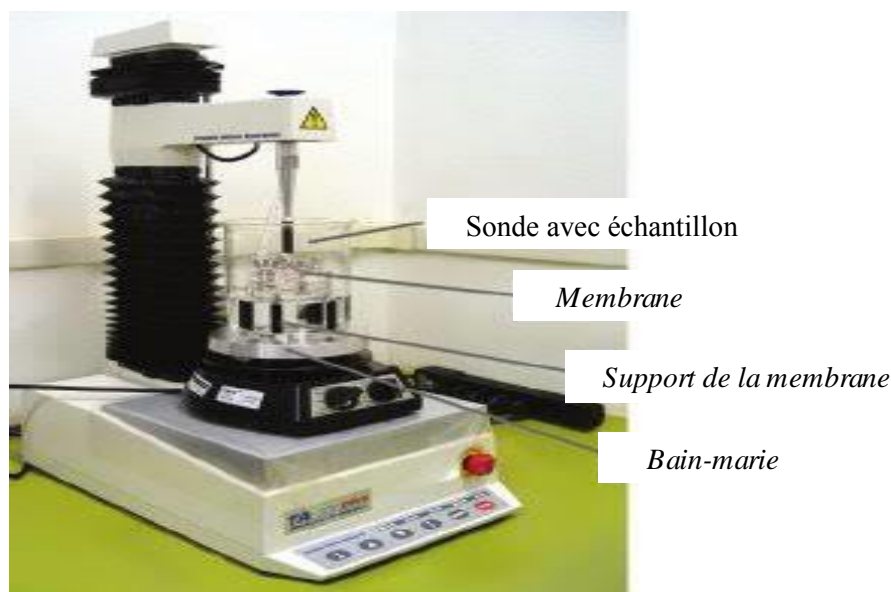
Figure 3.4 : Appareil pour déterminer la mucoadhésion 'analyseur de texture' (Marcos Luciano et al, 2010).
