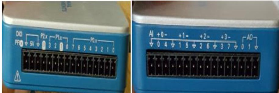
**Figure 2.2.** Les canaux de NI USB-6001
