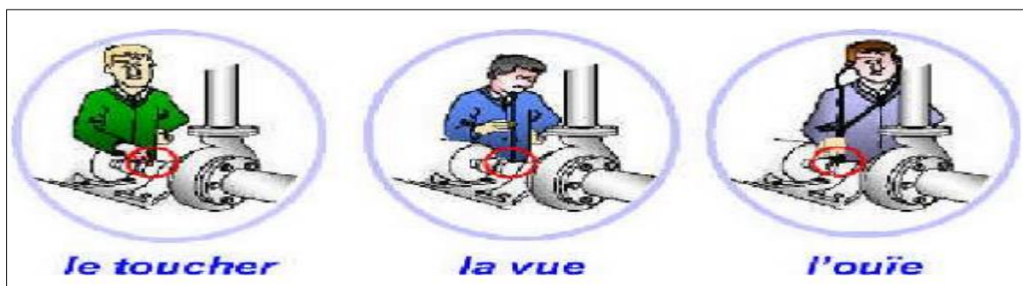
Figure 1-13 : Utilisation des sens pour mesurer la vibration
