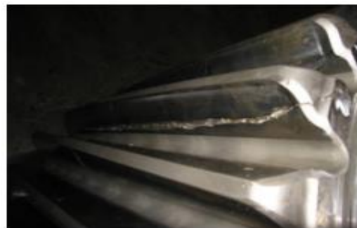
Figure1-4 : Fissuration ou cracks
