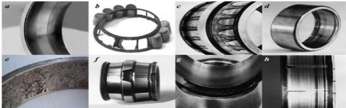
Figure 1-5 : Quelques défaillances affectant les roulements a- Usure généralisée b- Cage détériorée c-Corrosion d- Présence de cratères e- Écaillage f- Fissure et cassure g- Grippage h- Traces d'empreintes
