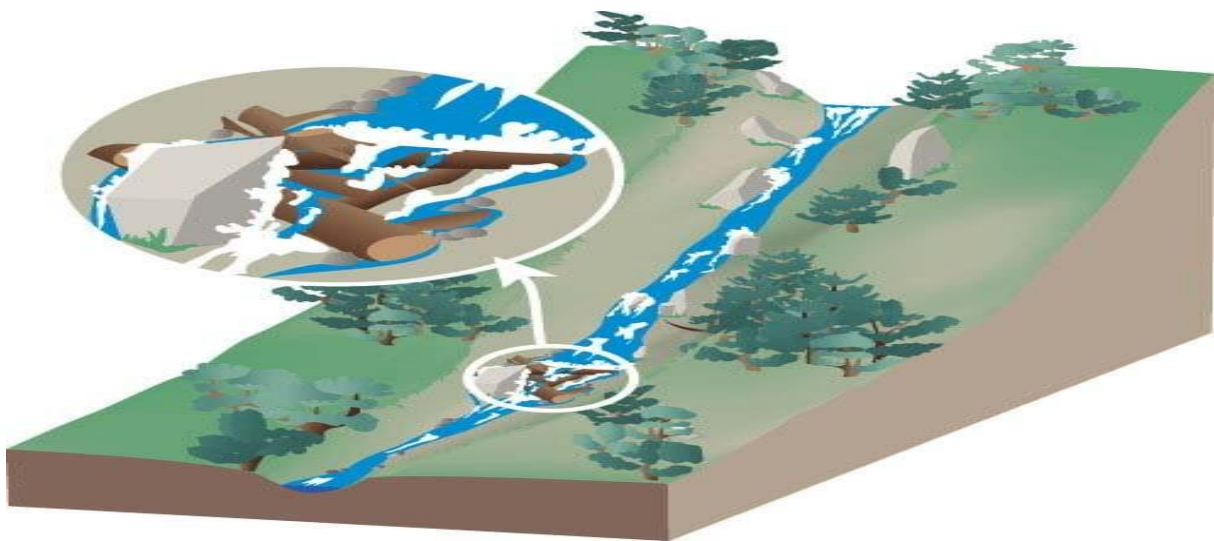
Figure V.5 Embâcle sur un torrent [12]
