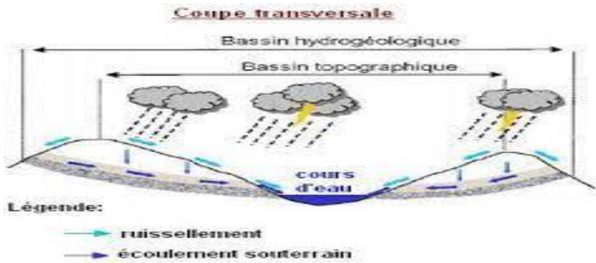
Figure III 2 Bassin versant topographique et bassin versant réel [5]
