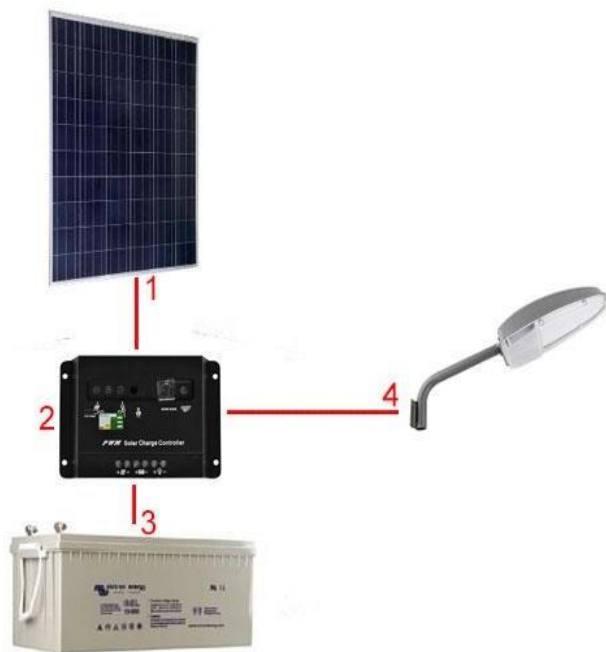
Figure I. 1: schéma d'un Lampadaire solaire isolé
