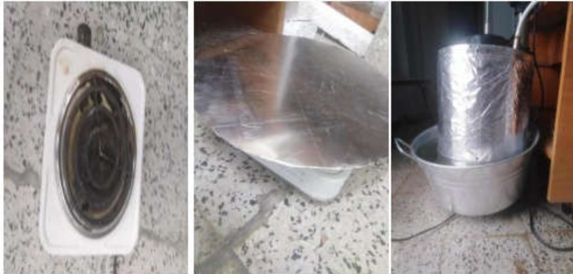
Figure 3 9:système de chauffage
