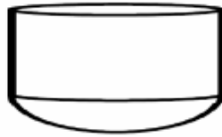
Figure 2 6:Forme du digesteur
