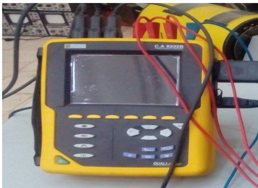
Figure 4.4. Représente l'analyseur de qualité d'énergie
