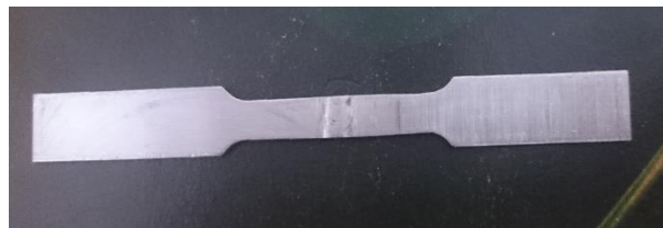
Figure III.14 : L'éprouvette de traction la norme ASTM (E8/E8M – 09) [33]
