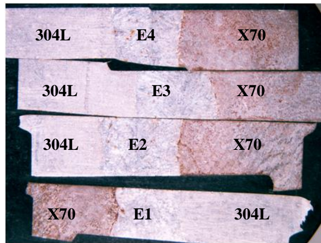
Figure IV.1 : Macrographie des joints soudés montre les différentes zones des assemblages
