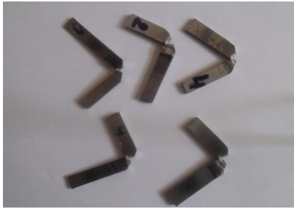
Figure IV.6: Epreuves après des essais de résiliences
