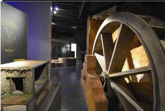
Figure 24:reproduction de la roue hydraulique Entrainant le moulin à sucre de Sidi Messaoud, Proche de Taroudannt. (Musée Aman 2018. Thierry Ruf1)
